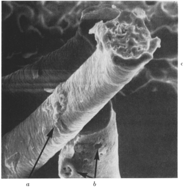
Abb. 14. Mehrere elektrisch geschädigte Haare. Bei a kugelförmige Formation (s. auch Abb. 10 und 11), bei c kelchförmige Abschmelzung mit glasflußähnlichen Oberflächen, bei b Oberflächenstruktur des Haares fein- bis grobkörnig, durchsiebt mit 2 größeren mulden- bis halbkugelförmigen konkaven Kratern mit charakteristischer Struktur bei Erhaltung der Grundform des Haares
